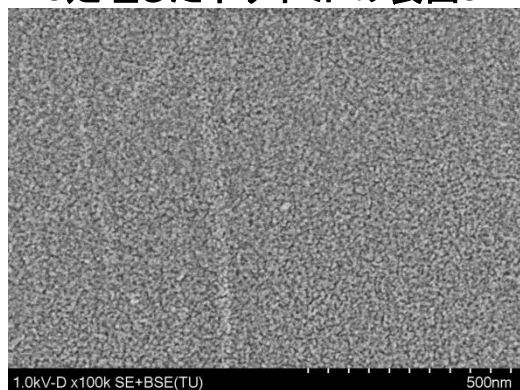
TPS処理したポリイミドの表面SEM
